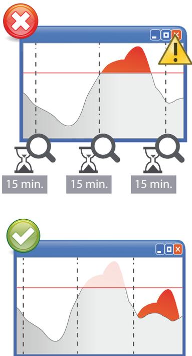
Dépassement de la puissance souscrite 250kVA/400A
